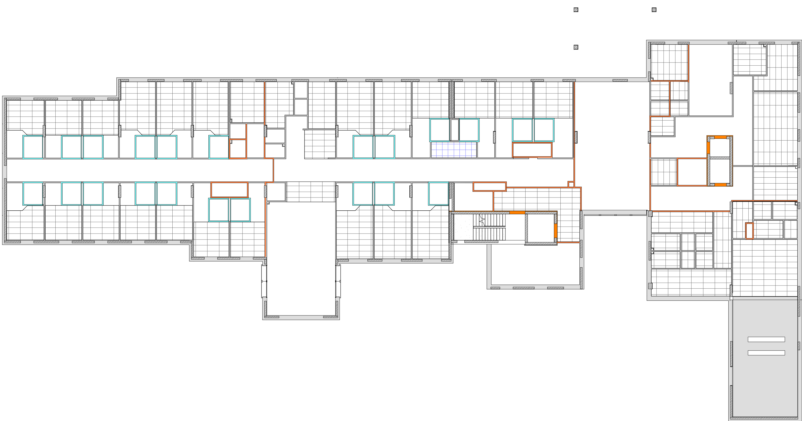
Controsoffitto Piano Primo H 2,70
