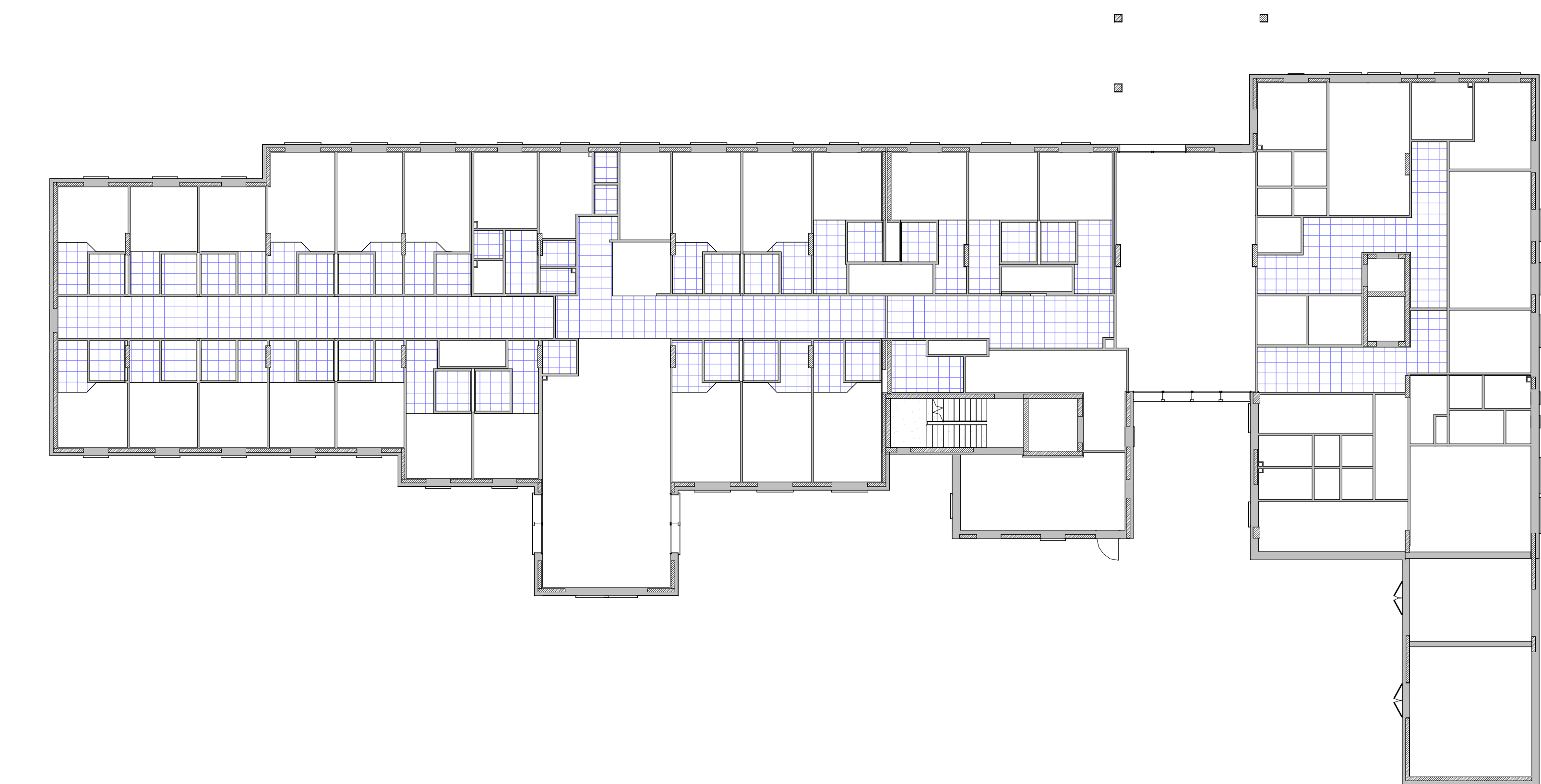
Controsoffitto Piano Primo H 2,40
